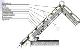
Die STROTEX 1300 Folie wird direkt auf Wärmeisolierung gelegt. Die hohe Dampfdurchlässigkeit der Folie ermöglicht die problemlose Abfuhr des Wasserdampfes.
